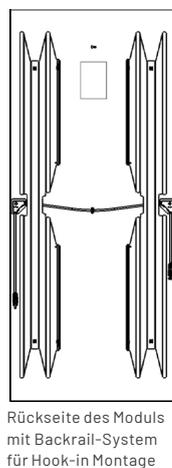
Rückseite des Moduls mit Backrail-System für Hook-in Montage
