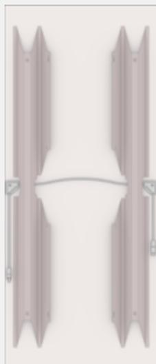
Zur Integration in eine VHF werden SKALA-Module mit einer aufgeklebten Rückenschiene (Backrail) *Hook-in* versehen und über eine Einhängemontage installiert. Das Agraftensystem wird auf der Rückseite über Klemmen mit dem Backrail verschraubt und ist somit von vorn nicht sichtbar.
