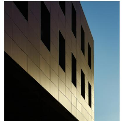
Neubau einer Lagerhalle mit kompletter Solarfassade der Nord-, Ost-, Süd- und Westseite des Firmengeländes. Die Solarfassade besteht aus grünen Standard- und längenreduzierten SKALA-Modulen, die 70 % des Eigenverbrauchs abdecken.
